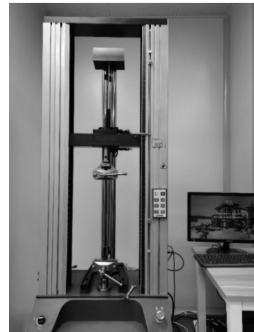
照片 1 CMT6503 型万能试验机
