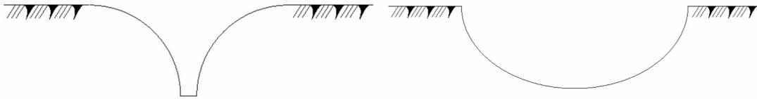
图6 反弧形断面水渠
